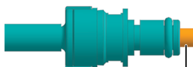
Válvula não empurrada para dentro (válvula vedada)
